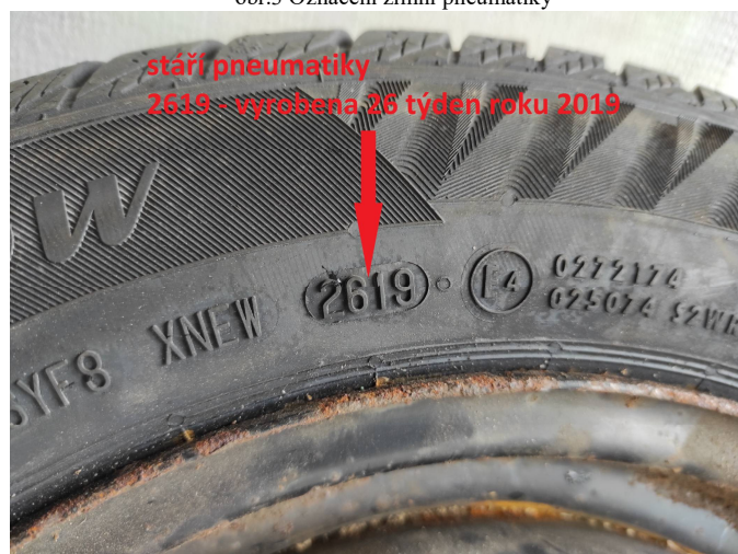
obr.5 Označení stáří pneumatiky
